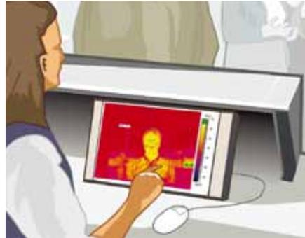
**Étape 2:** L'opérateur de la caméra infrarouge regarde un écran couleur ; une alarme de couleur et/ou sonore se déclenche lorsque la température corporelle sort de la norme.
