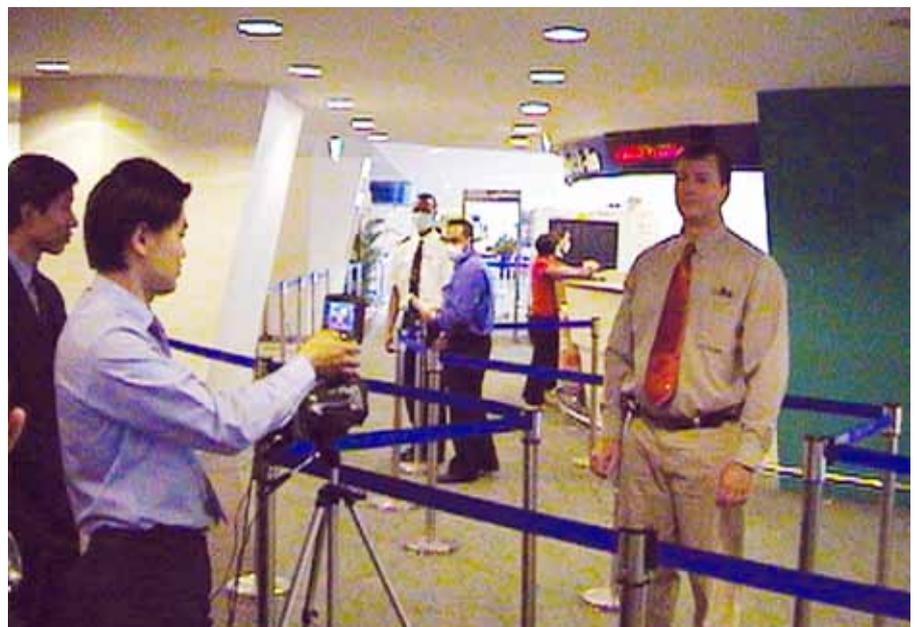
Mise en place d'une caméra infrarouge FLIR avec ATC (Automatic Temperature Compensator), pour la détection des températures corporelles élevées.
