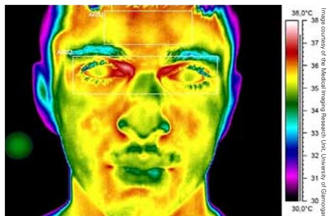
La température élevée de la peau peut indiquer une fièvre causée par une maladie infectieuse. Or les caméras infrarouges FLIR détectent automatiquement une température élevée. Chaque caméra est dotée d'un ATC (Automatic Temperature Compensator), un dispositif qui corrige les relevés en fonction des conditions environnementales. Grâce à l'image en couleur, à son échelle de température et à l'alarme, l'opérateur peut facilement décider de diriger la personne vers un examen plus approfondi.
