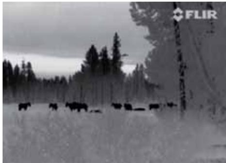
La caméra thermique portable FLIR Scout TS32 Pro permet à l'utilisateur de choisir si les objets chauds sont représentés en blanc ou en noir.
